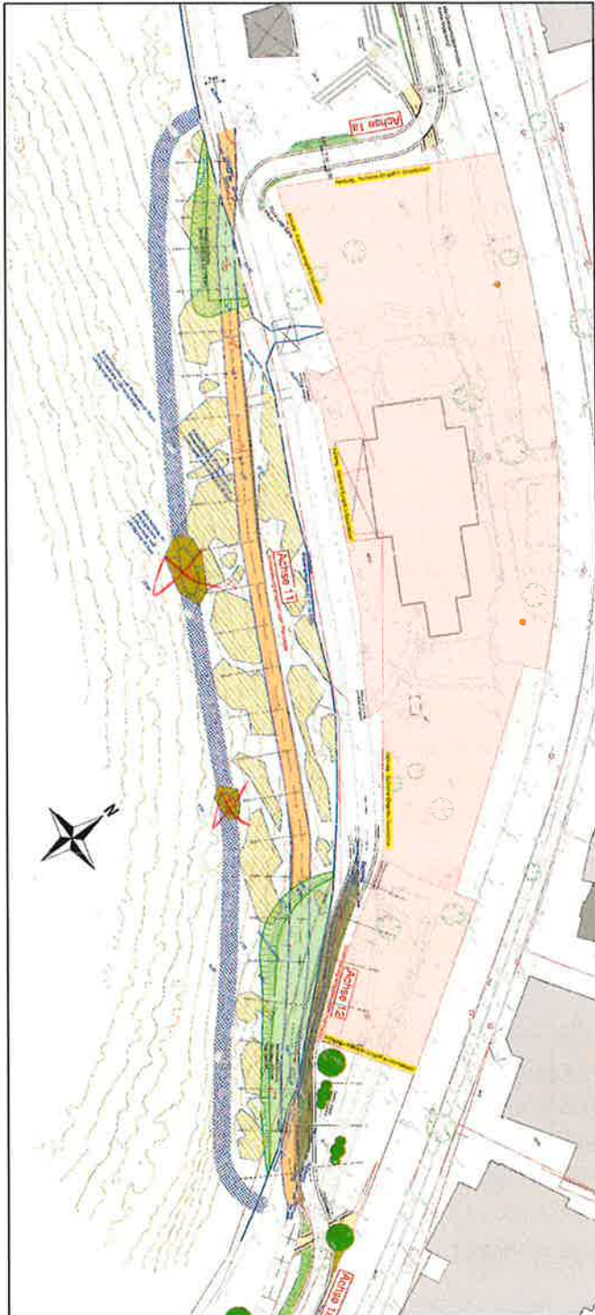
Abb. 1: Entwurf Steg Stand 28.02.24 - ohne Maßstab; Steg in gelb, Eisgangschutz in blau, temporäre Aufschüttungen in grün (Quelle: Rösel Landschaftsarchitektur und IB Klinger)
