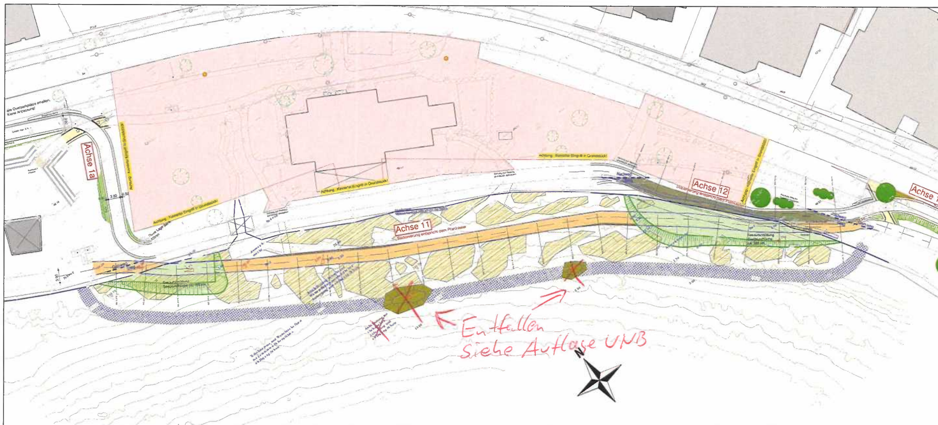
Abb. 1: Entwurf Steg Stand 28.02.24 - ohne Maßstab; Steg in gelb, Eingangsschutz in blau, neue Inseln in oliv, temporäre Aufschüttungen in grün (Quelle: Rösel Landschaftsarchitektur und IB Klinger)
