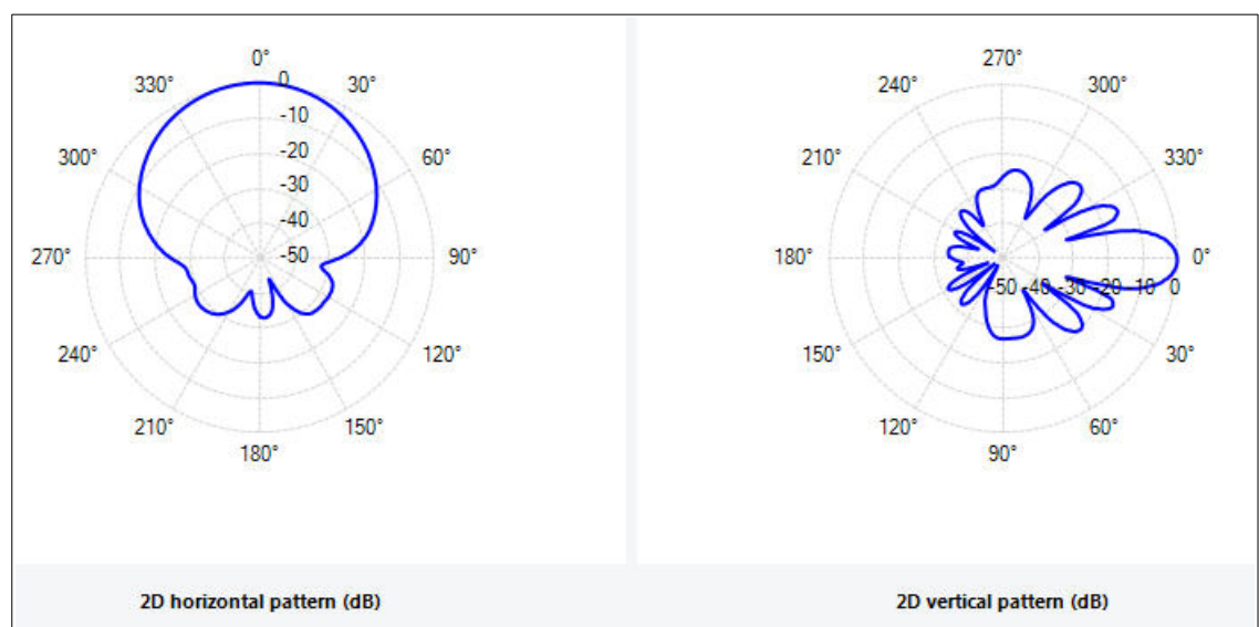
Abbildung 3.4: Antennendiagramm einer Sektorantenne
